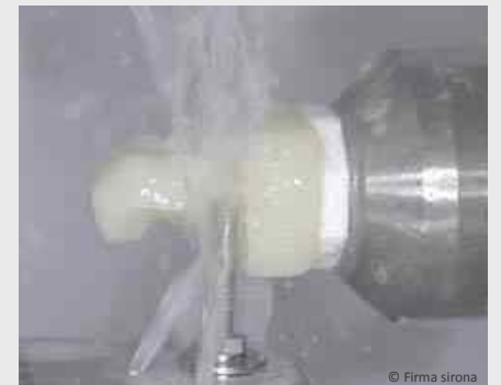
Das Inlay wird innerhalb weniger Minuten aus einem Keramik-Block gefräst.
